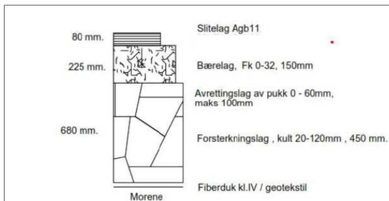
Figur 12. Oppbygning med nytt forsterkningslag.
